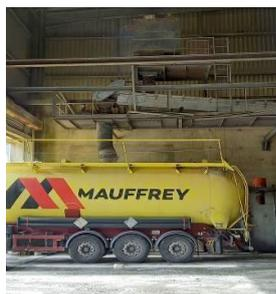
Les Résidus d'Épuration des Fumées d'Incinération des Ordures Ménagères sont constitués des résidus issus du dépoussiérage et du lavage des gaz (cendres, gâteaux de filtration, réactifs). Ils représentent **3,51 % du tonnage** des ordures ménagères incinérées. Ils sont évacués par SUEZ et éliminés à l'ISDD de Villeparisis (77) et sur le site du SEDA à Chenillé-Champeussé (49)
