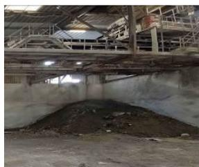
Les mâchefers sont les résidus d'incinération récupérés en sortie de four. Ils sont composés de verre, silice, alumine, calcaire, chaux, métaux ferreux et non-ferreux, sels, eau et composés organiques...
